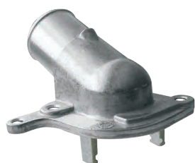
Toma de Agua
